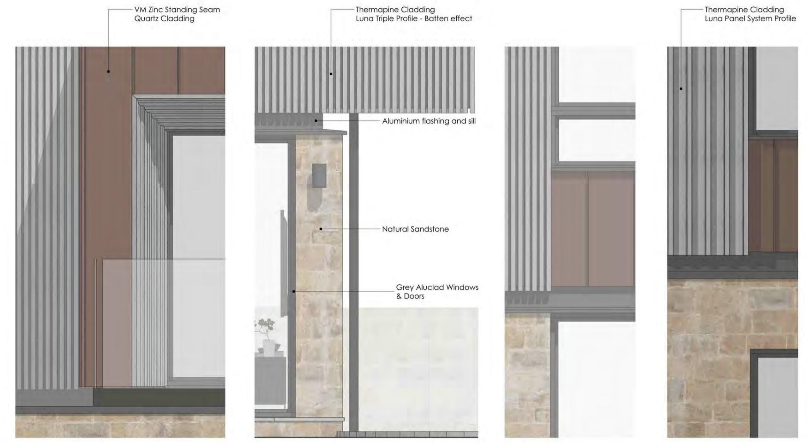
Material Details scale: 1:20
